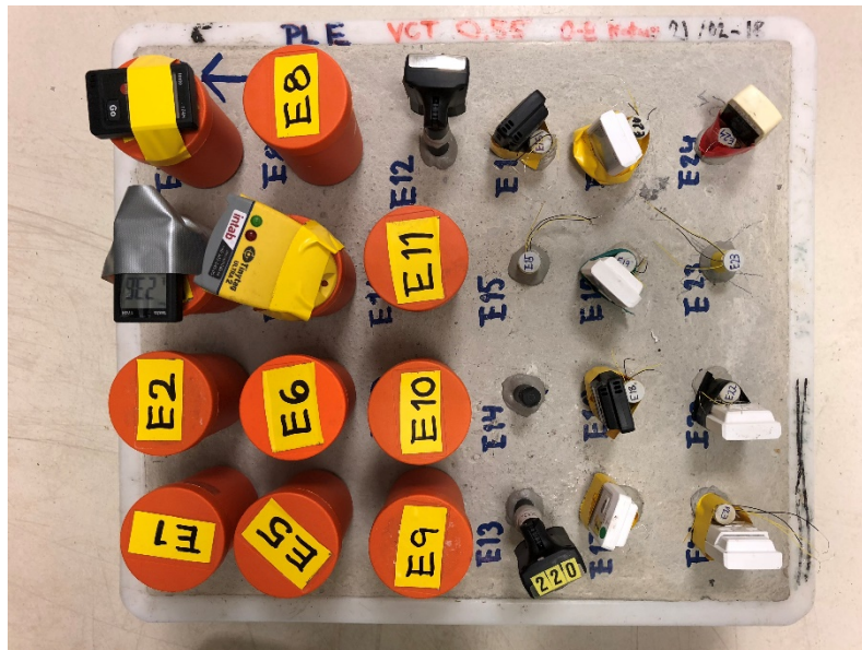
Fig. 7 Exempel på platta gjuten i back med 24 mätpunkter från Sveriges Byggindustrier. Från bl.a. sådana kom mätdata som fick ersätta de läckande valideringshinkarna.
