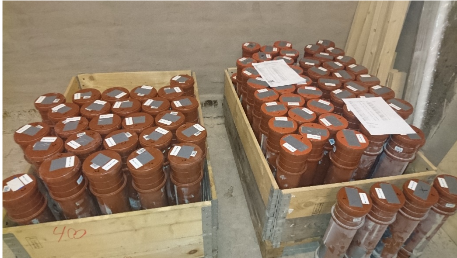
Fig. 1 Förseglade cylindrar som härdats initialt i temperaturstyrda vattenbad, på bilden under lagring i klimatrums för senare tillverkning av olika provkroppar.
